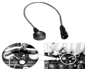
Widok czujnika stuku oraz jego lokalizacja w silniku Holdem 2,2 MPFI samochodu Lublin II
