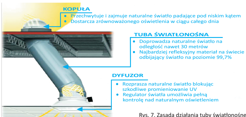
Rys. 7. Zasada działania tuby światłonośnej
