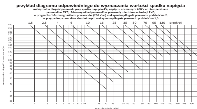
Rys 13.1 Przykład diagramu do wyznaczenia wartości spadku napięcia
