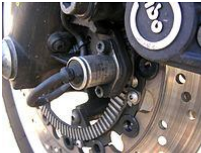
Rys. 2 Układ pomiarowy mierzący prędkość obrotową należący do systemu ABS
