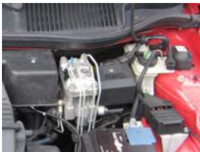
Rys. 3 Jednostka sterująca wraz z zaworami hydraulicznymi systemu ABS w samochodzie Fiat Punto rocznik 1995.
