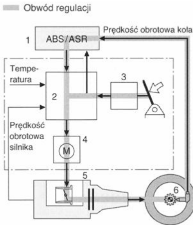
Rys.4. Elektroniczne sterowanie silnikiem za pomocą pedału EGAS w układzie ASR: 1 - sterownik ABS/ASR, 2 - układ sterujący z funkcją EGAS, 3 - czujnik położenia pedału przyspieszenia, 4 - nastawnik, 5 - przepustnicę (lub pompę wtryskową), 6 - czujnik prędkości obrotowej koła
