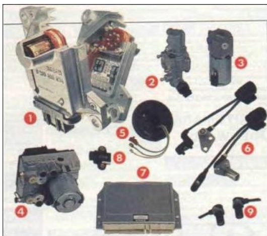
Rys.3 Elementy składowe układu ESP firmy Bosch:
