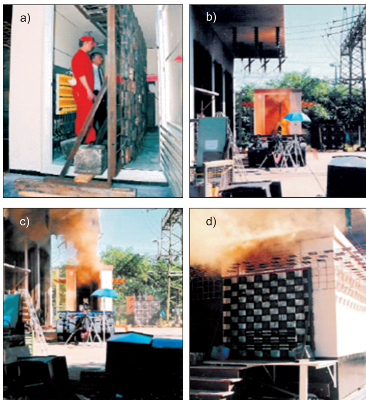
Rys. 11. Próba bezpieczeństwa obsługi (a), b), c) oraz osób postronnych d), przy zwarciu łukowym w kontenerowej stacji z korytarzem dla obsługi [20, 21, 22, 23, 24].
