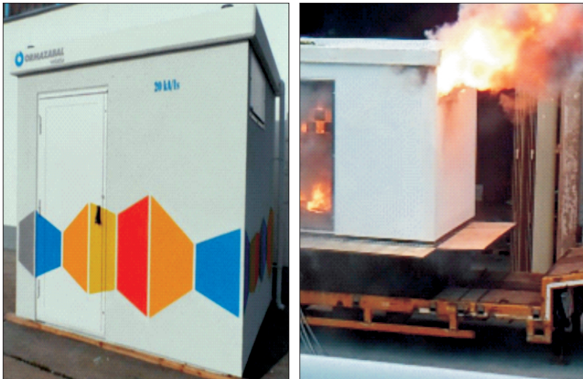
Rys. 8. Obudowa elektroenergetycznej stacji transformatorowej SN typu PF-P, z potwierdzoną odpornością na skutki zwarć łukowych przy prądzie I_k = 20 kA i czasie zwarcia 1s [2, 3, 6, 18].
