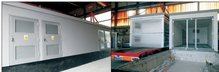
Rys. 14. Moduły zestawione na hali produkcyjnej oraz przygotowane do transportu, pojedynczo, na plac budowy, z uwidocznieniem ścian portalowych
