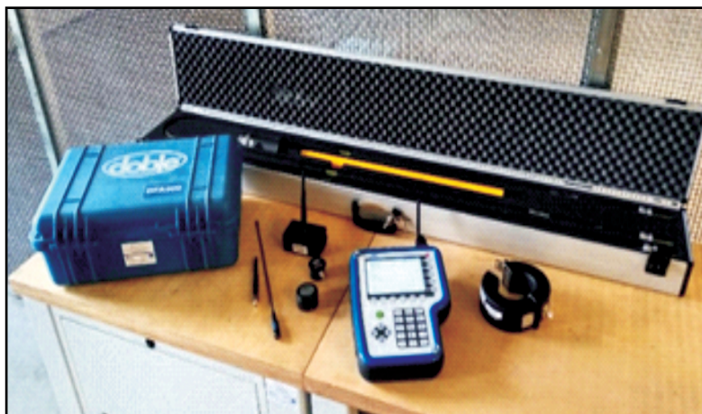
Rys. 5: System pomiaru i analizy WNZ metodą elektryczną
