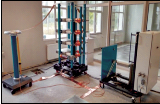
Rys. 9: Generator napięć udarowych 400 kV
