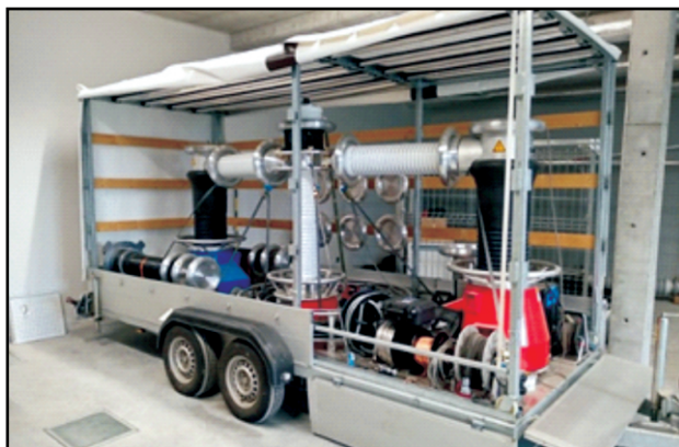
Rys. 7: Mobilny system probierczy i pomiarowy do badań off-line linii WN i SN
