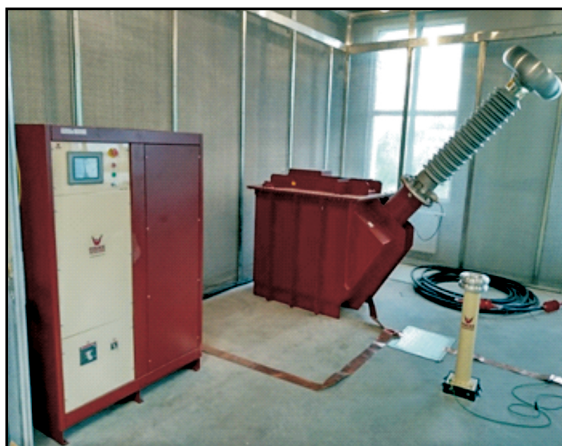
Rys. 5: System pomiaru i analizy WNZ metodą elektryczną
