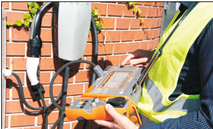
Rys.1. Pomiary stacji ładowania pojazdów za pomocą SONEL EVSE-01 i MPI-540.
