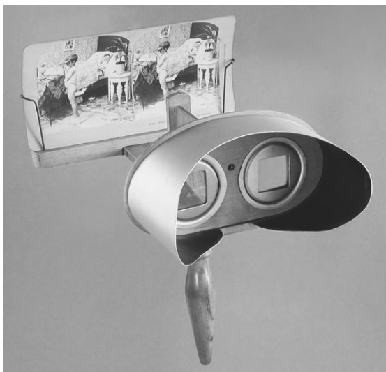
Rys. 3 Stereoskop Holmesa, skonstruowany w roku 1861, model z roku 1900 wykorzystujący odbitki zdjęć stereoskopowych
