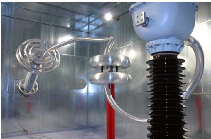
Stacja prób w laboratorium ABB w Przasnyszu. Przekładnik podczas próby wyrobu.
