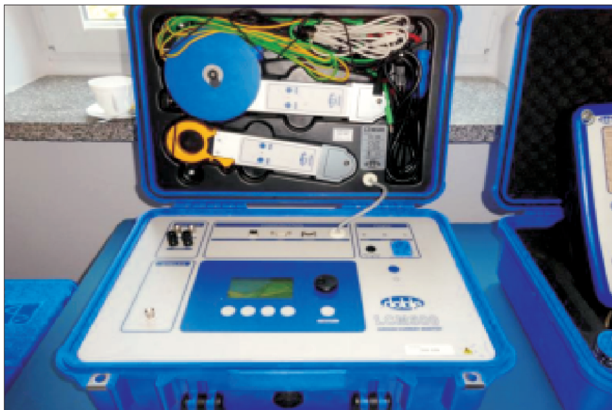
Analizator prądu upływu warstwowych ograniczników przepięć ŚN oraz WN firmy Doble Lemke
