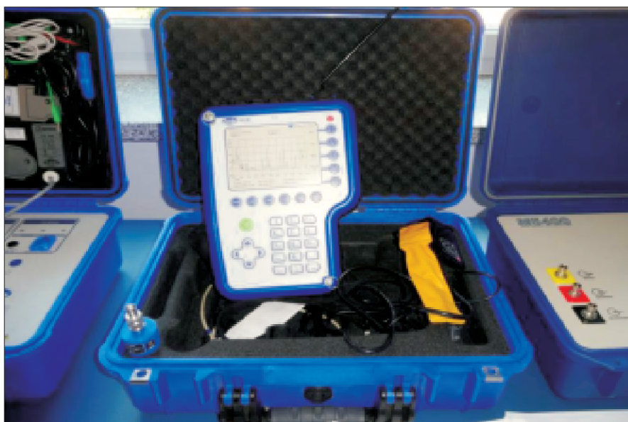
Analizator prądu wyładowań niepełnych firmy Doble Lemke stosowany w przeglądach okresowych rozdzielnic i stacji trafo
