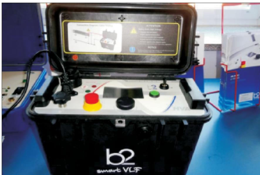
Przyrząd diagnostyczny linii kablowych metodą rezonansową austriackiej firmy b2 Hight Voltage
