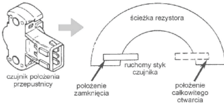
Czujnik położenia przepustnicy
