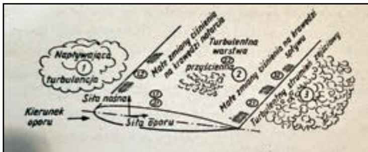
Rys. 1 Mechanizm generacji hałasu aerodynamicznego na krawędzi profilu wirnika A. Chyła, Prace Instytutu Lotnictwa, Nr 101, Warszawa 1982
